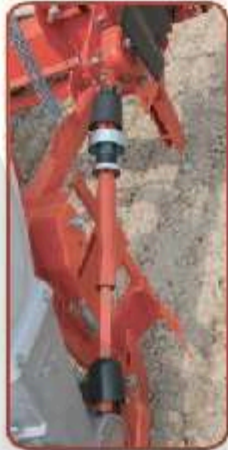
Accionamiento por medio de flecha cardán (sin cadenas)
